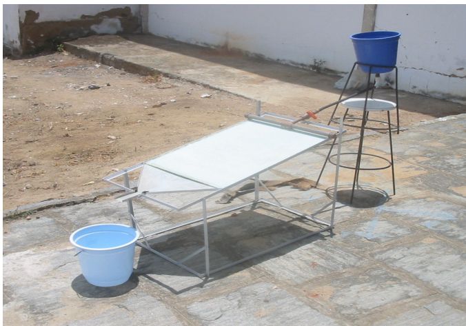
Figura 7- Reator fotocatalítico de placa plana (segunda e terceira etapas)
