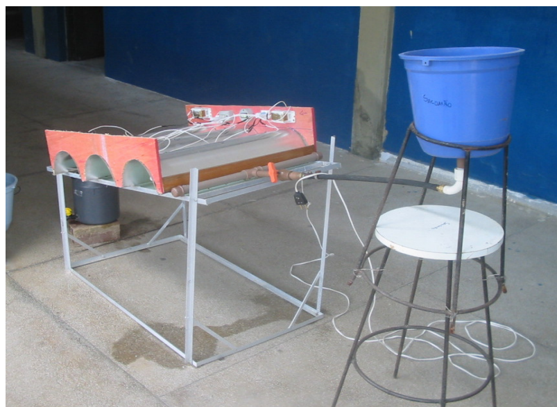
Figura 9- Refletores parabólicos montados acima do fotorreator
