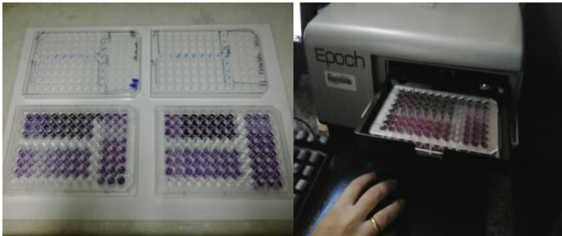
Figura 3 - Ensaio de MTT: redução do sal de MTT e leitura das microplacas
