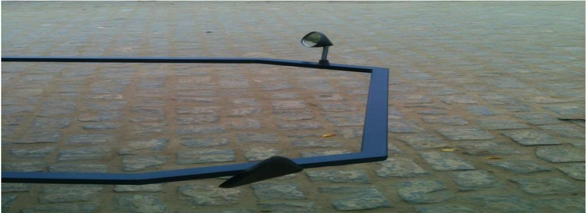
A altura das pegas (local onde os catadores seguram o transporte na hora da coleta dos materiais recicláveis) é regulada por um pino e uma barra móvel, facilitando assim, a adequação de entrada e saída do usuário de acordo com sua altura, evitando, o uso desnecessário das articulações do joelho e coluna (Figura 18) dos catadores de materiais recicláveis.
