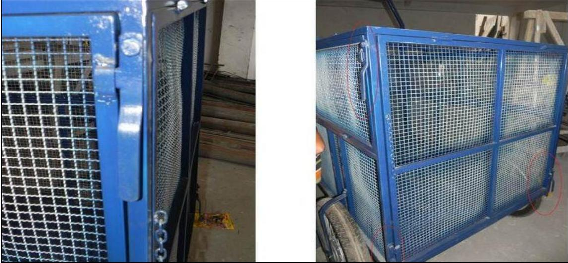
O T5 continuou com o formato de gaiola. A sustentação de todo esse material é feita por um conjunto de barras de seção retangular interligadas por solda, não havendo barras de ligação (Figura 13), diminuindo assim, os custos e peso do transporte.
