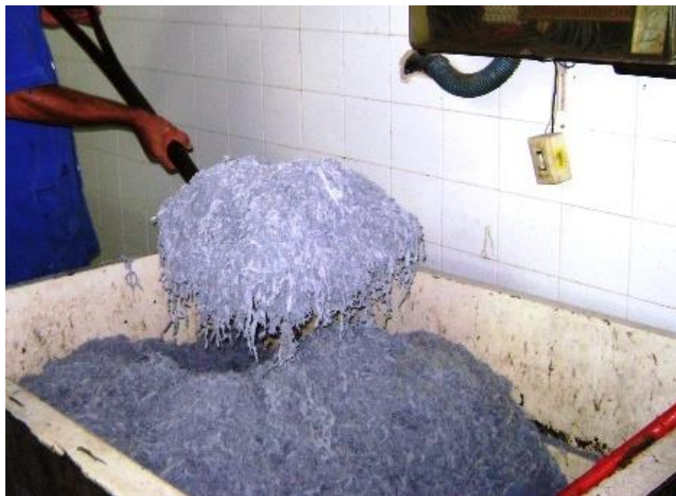
Foto 07 – Pó do couro curtido ao Cromo III advindo da Rebaixadeira Fonte: Direta, 2013
