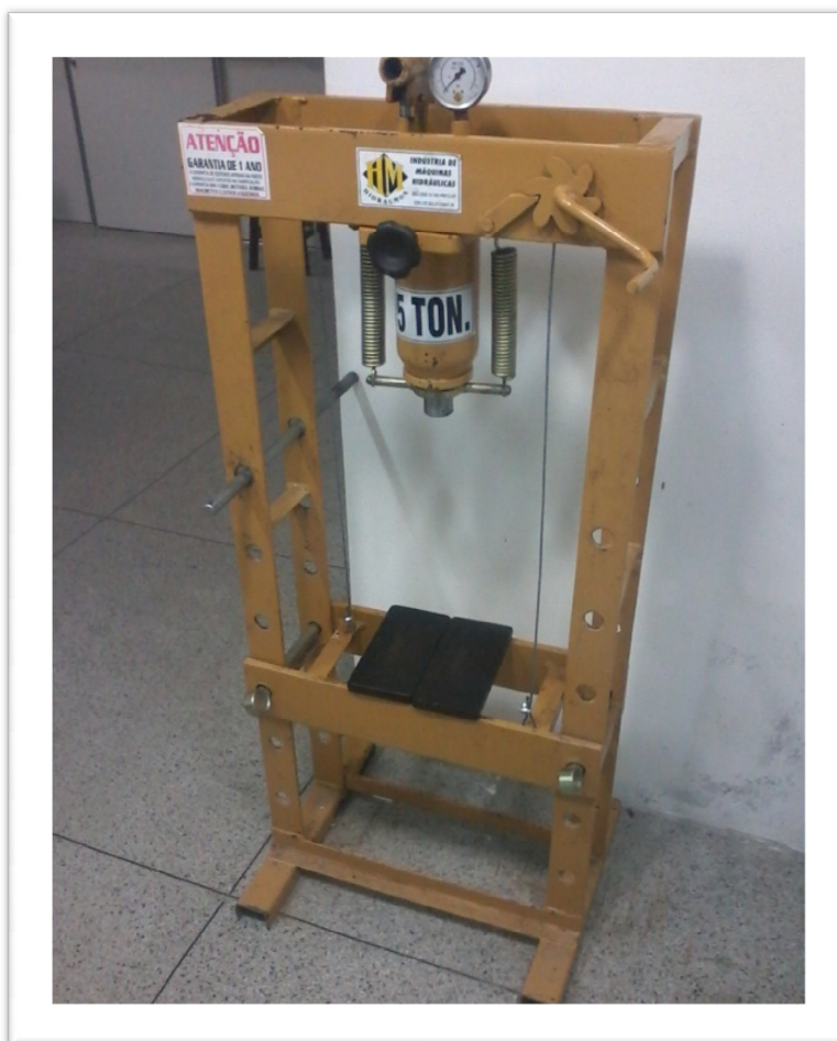
Figura 2 - Prensa hidráulica de 15 toneladas (Fonte: Própria).
