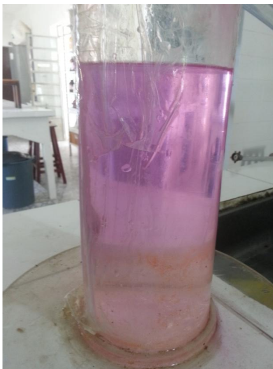
FIGURA 6: Solução do reator de recolhimento após a neutralização da amônia.
