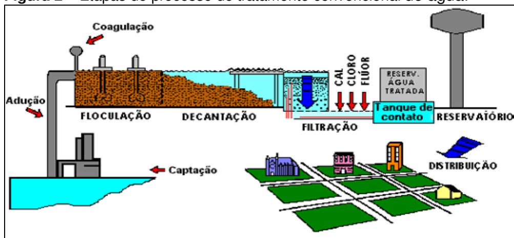
Figura 2 – Etapas do processo de tratamento convencional de água.
