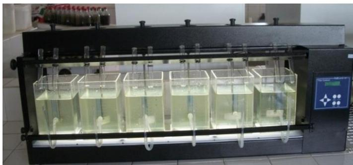
**Figura 5:** Equipamento de *Jar Test* utilizado nos ensaios de coagulação, floculação e sedimentação.
