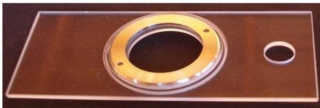
**Figura 4:** Câmara de Uthermöhler de 2 cm de altura.
