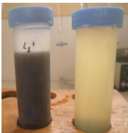
.Evidencia-se, na Figura 14, que o lixiviado tratado permaneceu com uma coloração levemente amarelada, podendo ser explicado, devido à presença de ferro pelo emprego do  $\text{FeSO}_4 \cdot 7\text{H}_2\text{O}$ , já que este apresentou uma remoção 84%, permanecendo, conseqüentemente, com uma quantidade relativamente pequena na amostra.
