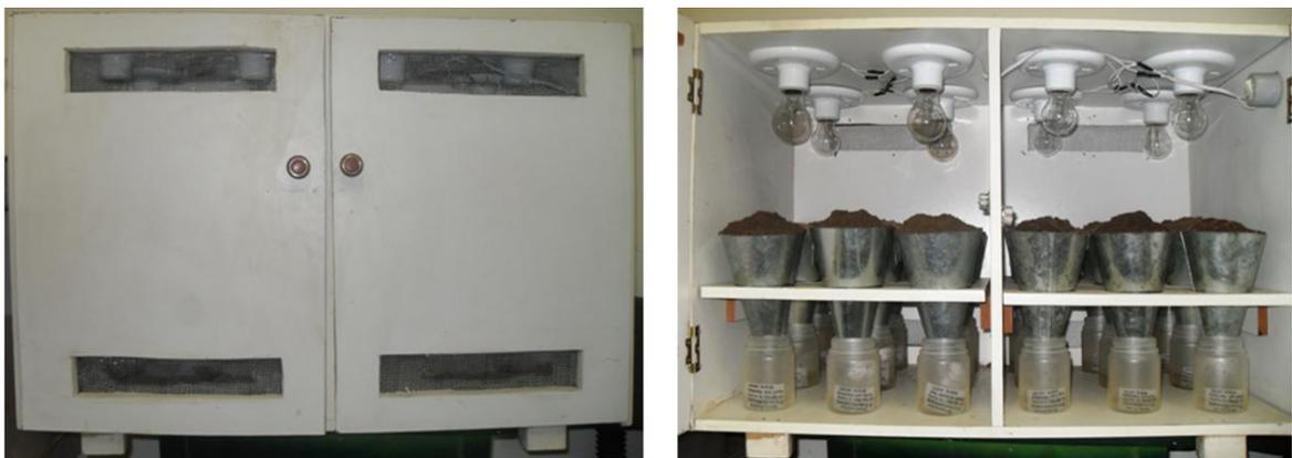
**Fig. 4.** Extrator de Berlese utilizado para amostragem dos cupins de solo em área de canavial. Usina Miriri. Paraíba. Brasil. 2013.
