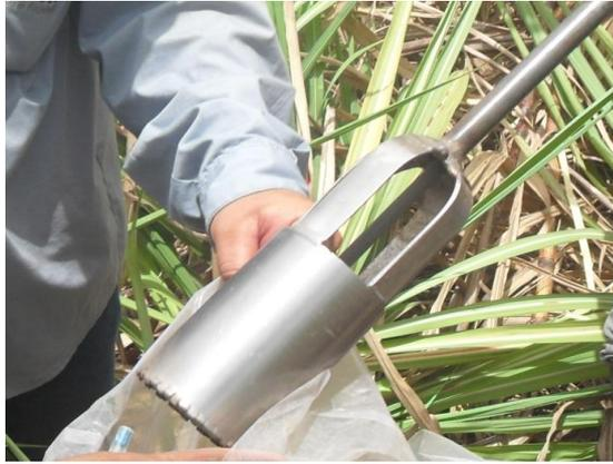
**Fig. 3.** Trado do tipo caneco utilizado para coletar cupins de solo até 45 cm de profundidade em área de canavial. Usina Miriri. Paraíba. Brasil. 2013.
