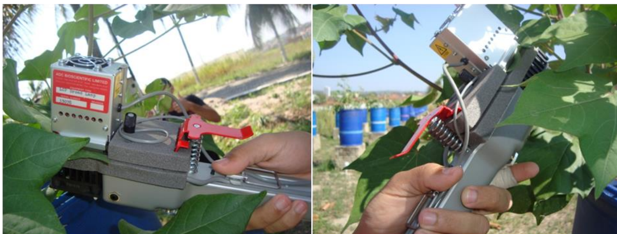
Figura 5. Mensuração das trocas gasosas em cultivares de algodoeiro com utilização de analisador de gás infra vermelho (IRGA). Campina Grande, PB, 2011.
