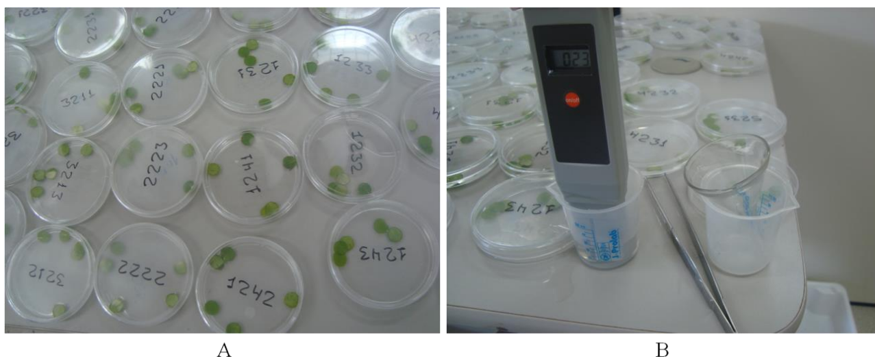
Figura 7. Placas de Petri contendo discos foliares (A) e aferição da condutividade da solução com condutivímetro portátil (B). Campina Grande, PB, 2011.
