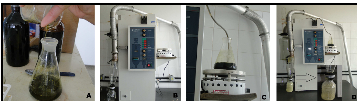
Figura 3 - Nebulização em aparelho Spray Dryer . A: mistura do extrato hidroalcoólico com o Aerosil 200 ® . B: Equipamento utilizado. C: Injeção do extrato no equipamento. D: Coletor do pó nebulizado.
