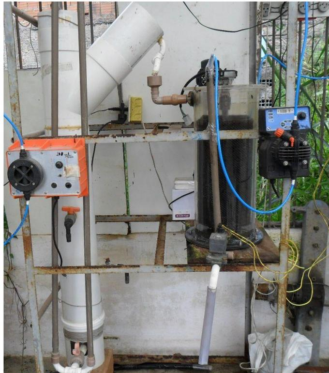
**Figura 3.** Foto do sistema combinado reator An/Ax seguido de RAMSI.
