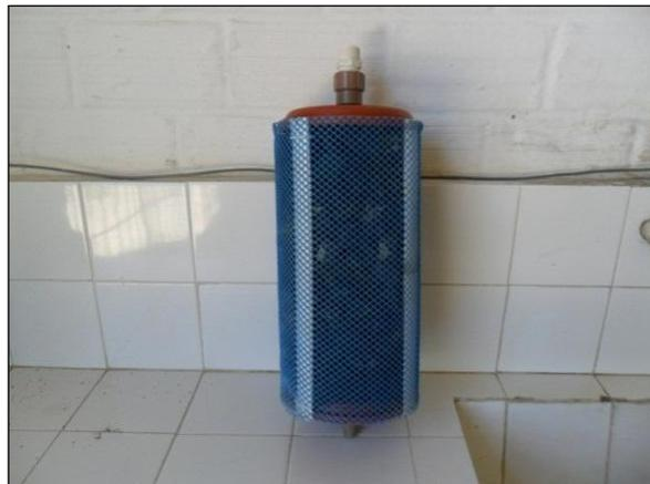
**Figura 6.** Imobilização da esponja de poliuretano em um dispositivo de PVC cilíndrico envolvido por uma tela de nylon e conectado a um agitador mecânico.
