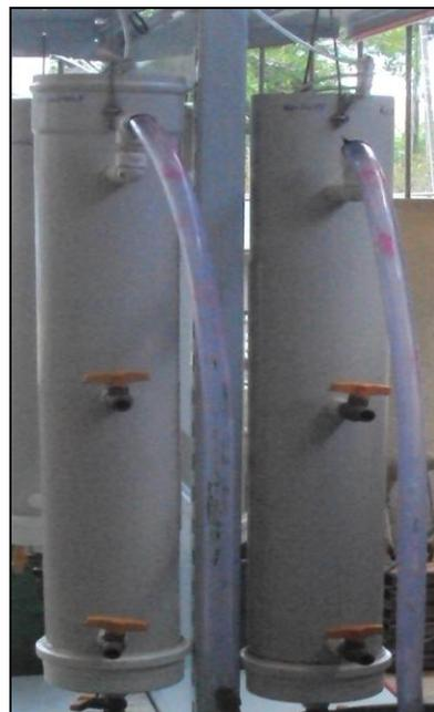
**Figura 3.3** - Caixa de equalização do sistema RBS1 e RBS2.
