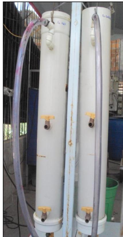
**Figura 3.3** – Esquema do sistema de alimentação dos sistemas RBS
