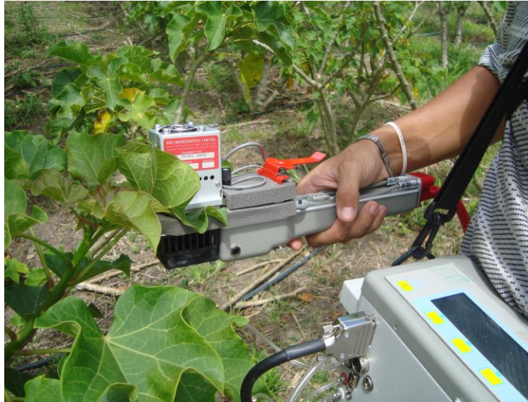
Figura 5. Avaliações de trocas gasosas utilizando o IRGA, no Pinhão manso sob diferentes níveis de condutividade elétrica da água de irrigação.
