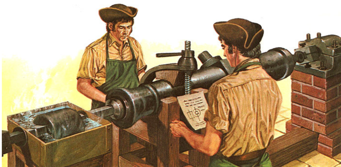
Figura 15: Ilustração 26 de um dos aparatos experimentais na perfuração de canhão, adaptado pelo conde Rumford para suas experiências de calor. O atrito como a broca embotada a cortar o metal produzia calor suficiente para fazer a água ferver.
