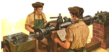
Figura 3: Ilustração de um dos aparatos experimentais na perfuração de canhão, adaptado pelo conde Rumford para suas experiências de calor. O atrito como a broca embotada a cortar o metal produzia calor suficiente para fazer a água ferver.
