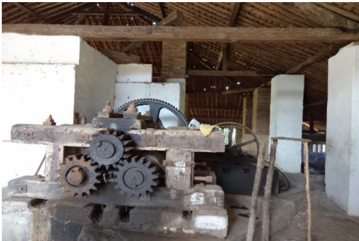
Foto 7: Moenda utilizada para extração do caldo da cana-de-açúcar – Engenho Mineiro
