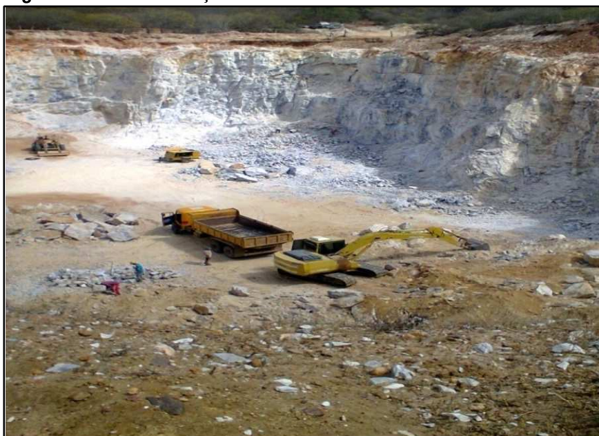
Figura 12 – Mecanização da lavra da rocha calcário
