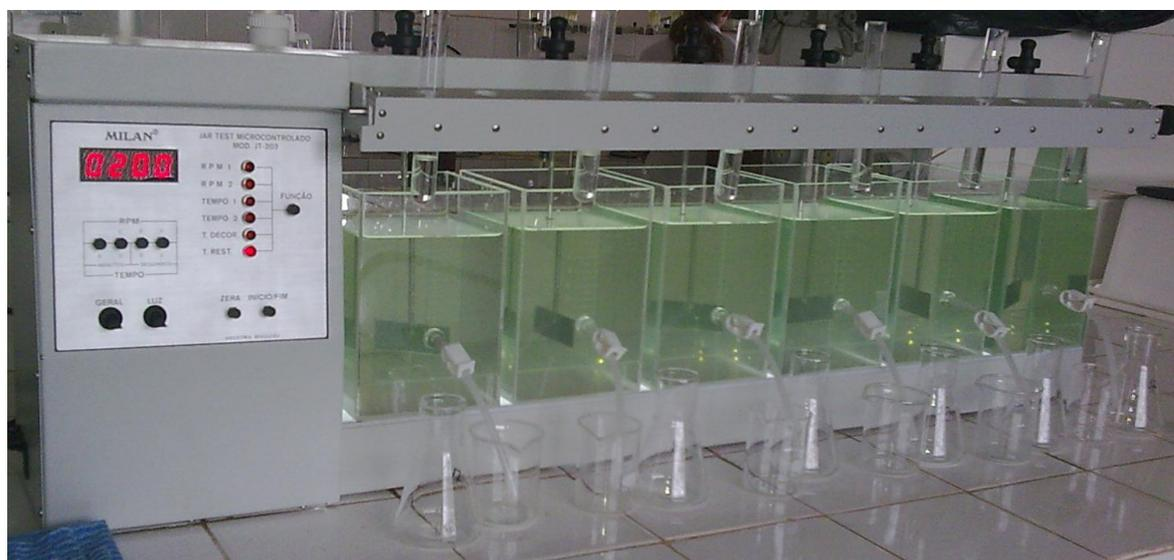
**Figura 8.** Ensaio de coagulação utilizando *Jar test*.
