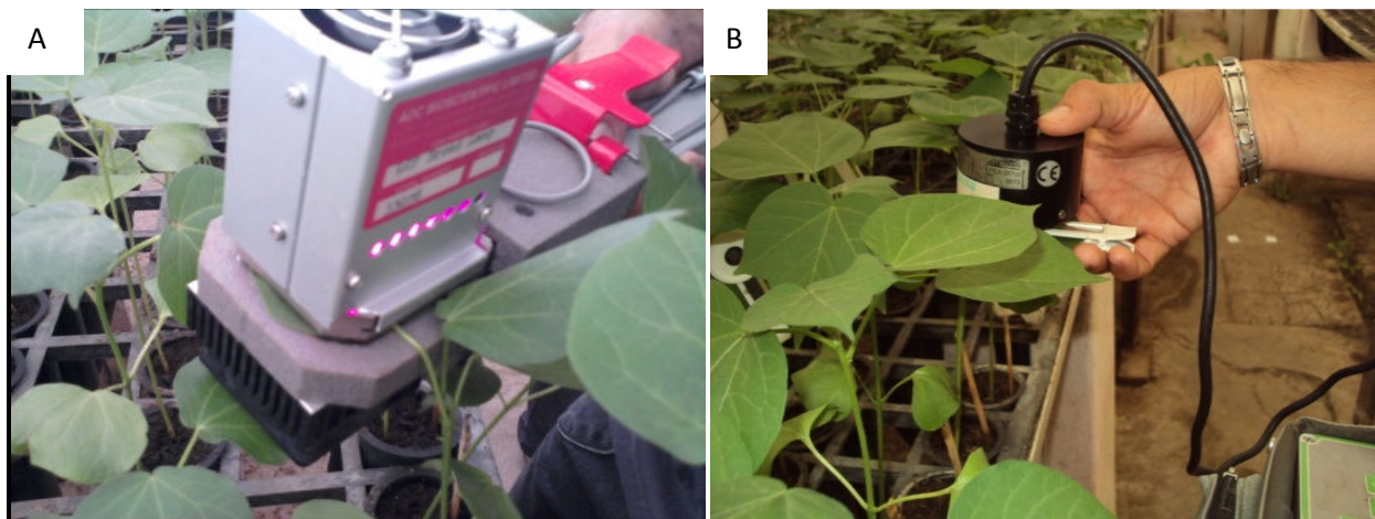
Figura 4. Utilização do IRGA para obtenção das taxas fotossintéticas (A) e da fluorescência (B), nos genótipos de algodão colorido, em função dos tratamentos. Campina Grande, 2012.
