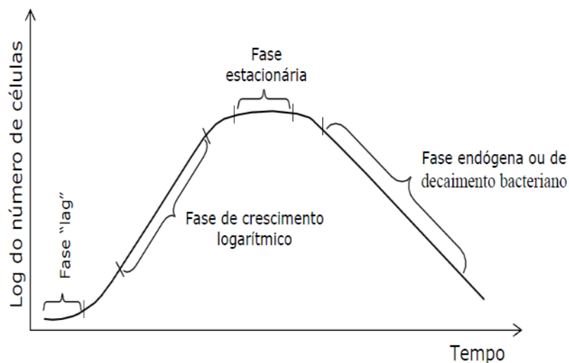
FIGURA 3: Curva típica do perfil de crescimento bacteriano ao longo do tempo em um sistema fechado
