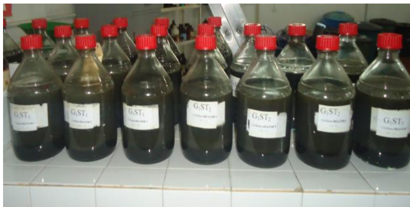
FIGURA 9: Reatores anaeróbios em batelada.
