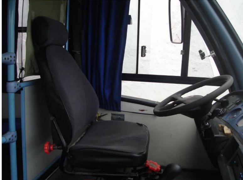
**Figura 4.10** - Posto de trabalho do motorista de micro-ônibus com cadeira com encosto para cabeça
