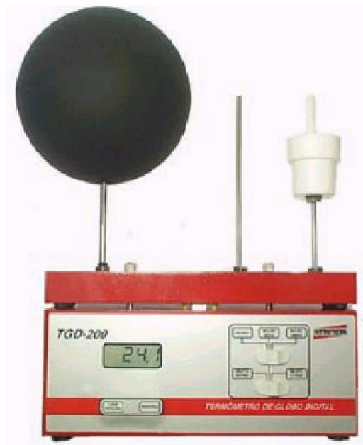
Termômetro de globo digital da marca Instrutherm modelo TGD-200
