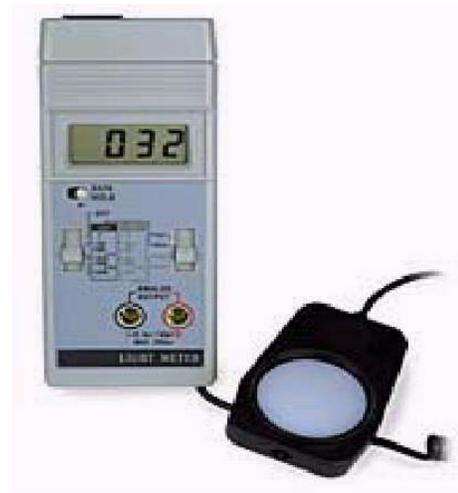
Luxímetro da marca Lutron modelo LX-102 Light Meter
