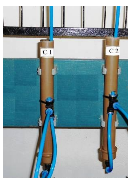
Figura 14. Colunas de carvão ativado granular.
