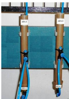
Figura 13. Filtros de areia utilizado no experimento.
