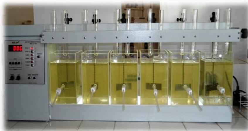
Figura 11. Equipamento de Jar Test utilizado nos ensaios de coagulação.
