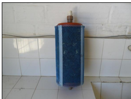
Figura 7. Imobilização da esponja de fibra sintética em um dispositivo de plástico cilíndrico envolvido por uma tela de nylon e conectado a um agitador mecânico.
