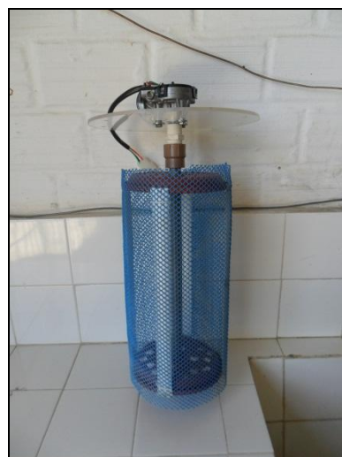
Figura 7. Imobilização da esponja de fibra sintética em um dispositivo de plástico cilíndrico envolvido por uma tela de nylon e conectado a um agitador mecânico.
