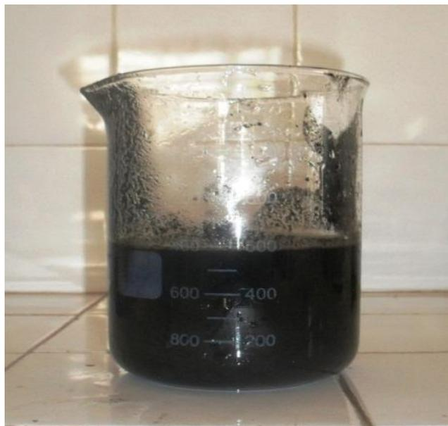
**FIGURA 2:** Lodo anaeróbico de esgoto sanitário.
