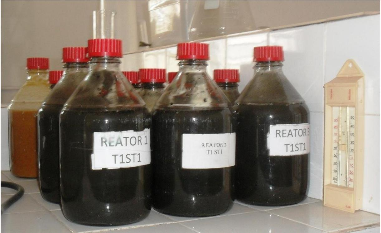
**FIGURA 6:** Reatores anaeróbios em batelada.
