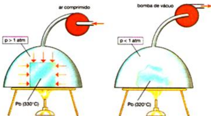
Fig. 13-12: Um aumento na pressão faz aumentar o valor da temperatura de fusão do chumbo.
