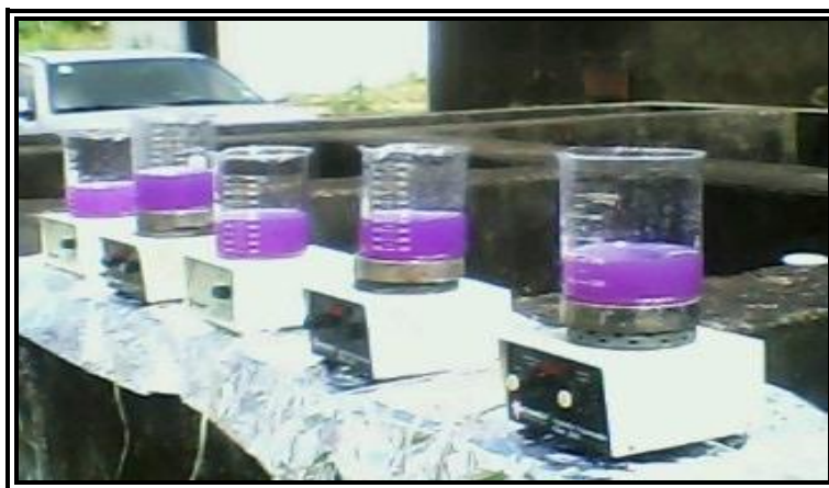
FIGURA 4: Processo para avaliar a degradação do corante utilizando radiação solar.
