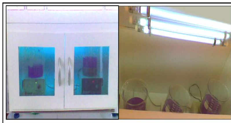
FIGURA 3: Reator fotocatalítico usado para avaliar a degradação do corante utilizando os catalisadores preparados.
