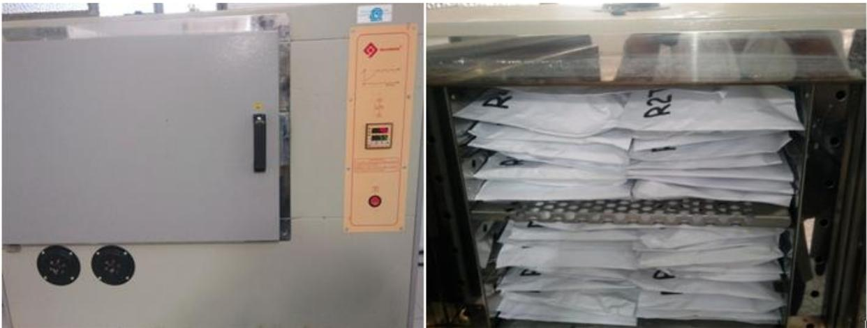
**Figura 12. Processo de secagem em estufa da matéria aérea e raízes.**
